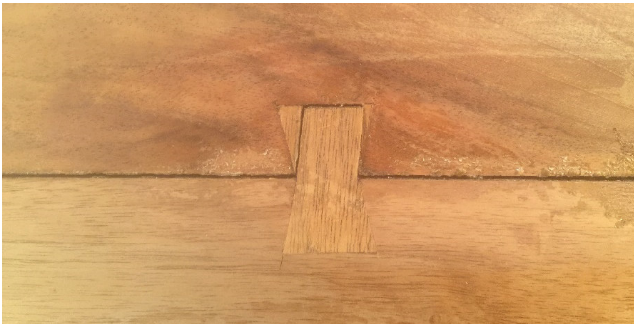
Abb.11: Deckel-Innenseite, Detail einer Schwalbenschwanzverbindung.
