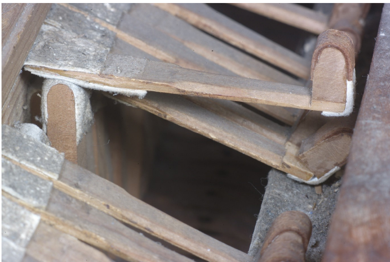
Abb.12: Detail Mechanik. Vom Stößer angehobener Hammerstiel.
