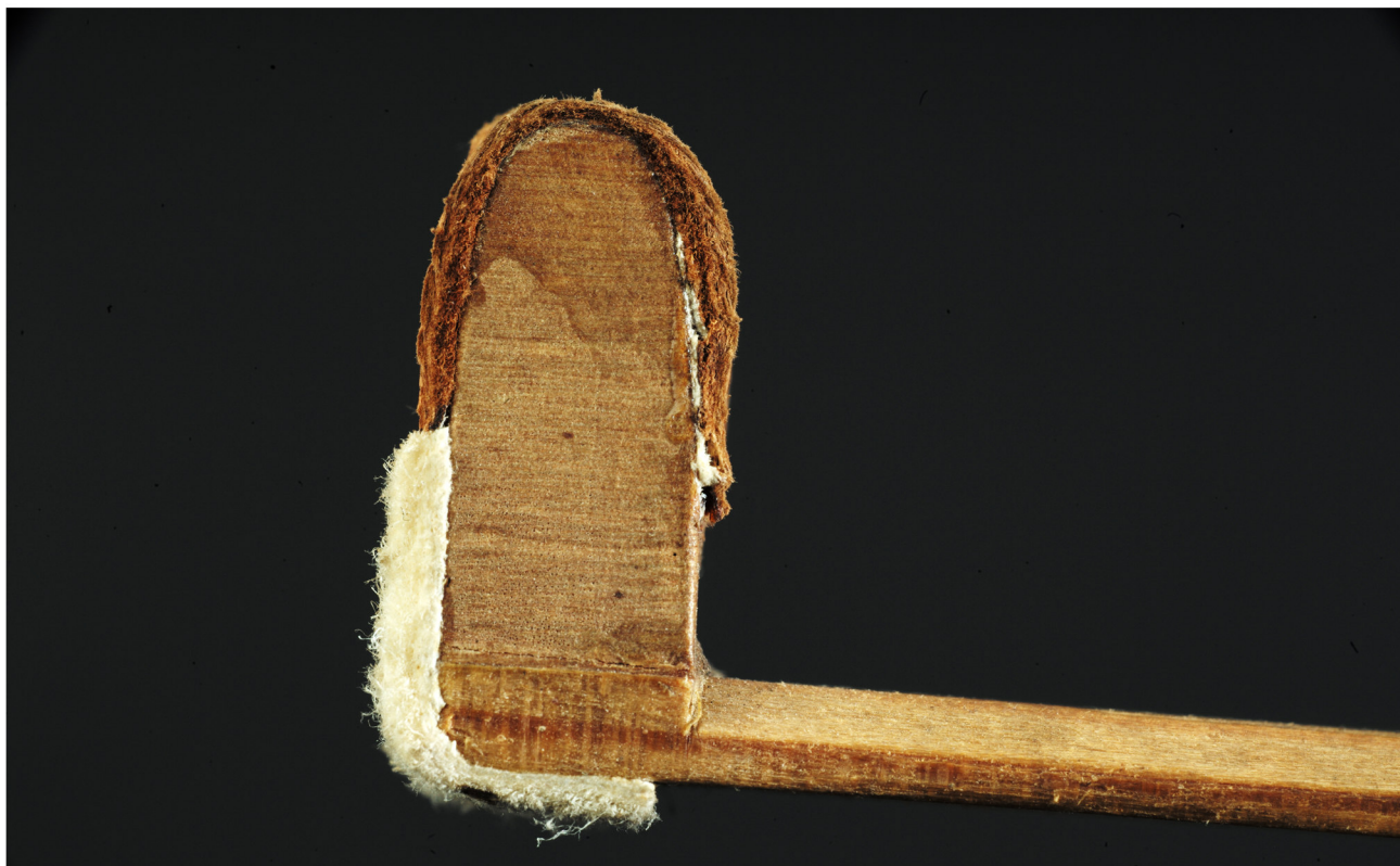
Abb.13: Detail Hammerkopf. Unter dem braunen Rindleder erkennbare, weisse Reste einer ersten Beledung, vermutlich mit Schafleder.
